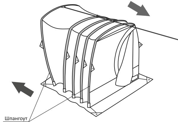
4.6. Собранные дверные каркасы вставить в полотна распашных дверей, застегнуть молнии поверх дверных каркасов.
