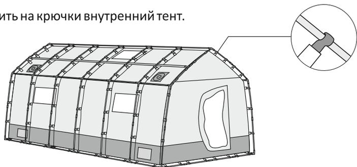
9. Одеть поверх силового каркаса внешний тент и закрепить его внизу по периметру при помощи крючков за трубки основания каркаса палатки.
