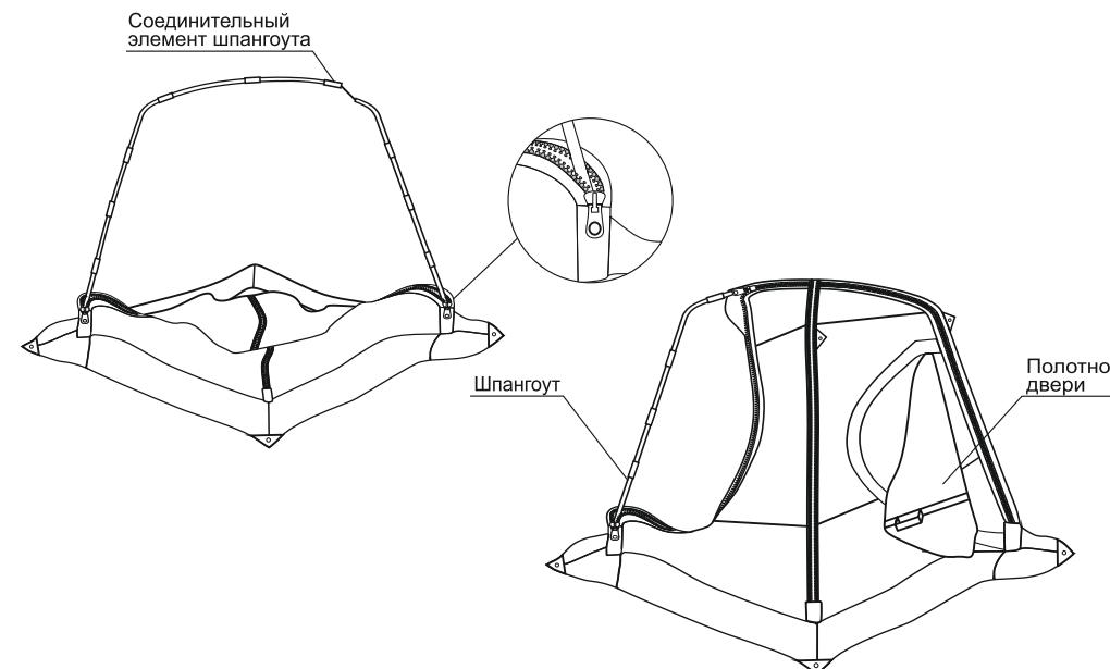
7. Собранный дверной каркас вставить в полотно распашной двери, застегнуть молнию поверх дверного каркаса.
